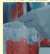
④ 最初に折り取った部分でパドルの塗料をかき落とす
